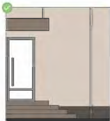
Водосточная труба соединена с ливневой канализацией
